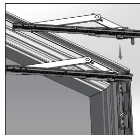
滑入窗扇前,窗扇需破槽口,装配好铝合页,螺丝拧紧。
